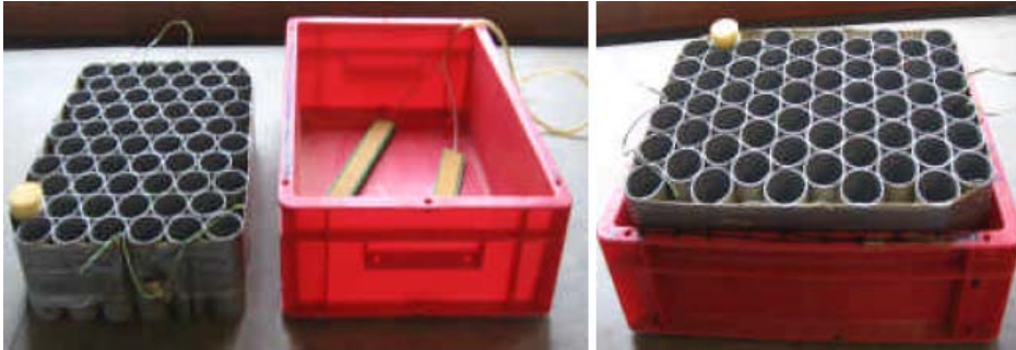
Abbildung 2: Aufbau des Hydrokultursystems
