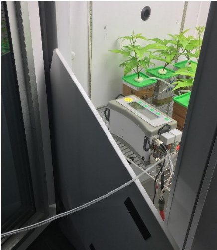
Abbildung 21: Versuch der Einflussreduzierung bei den Messungen: Geringere Eintrittsöffnung, Referenzluftschlauch führt in die andere Klimakammer.
