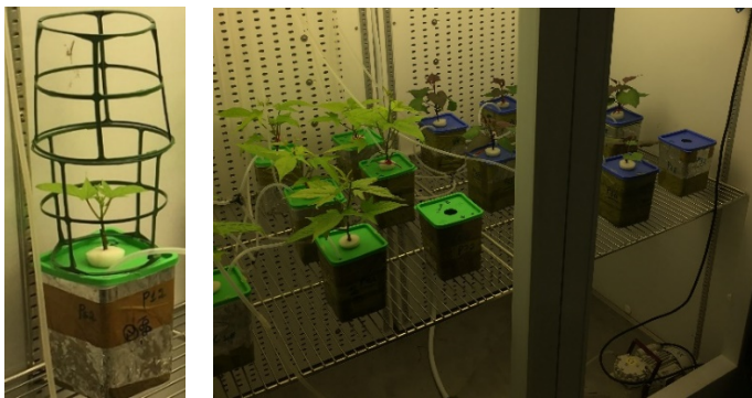
Abbildung 2: Hydroponik Topf mit Aluminiumfolienummantelung, Deckel mit Schaumstopfen und Belüftungsschlauch.
