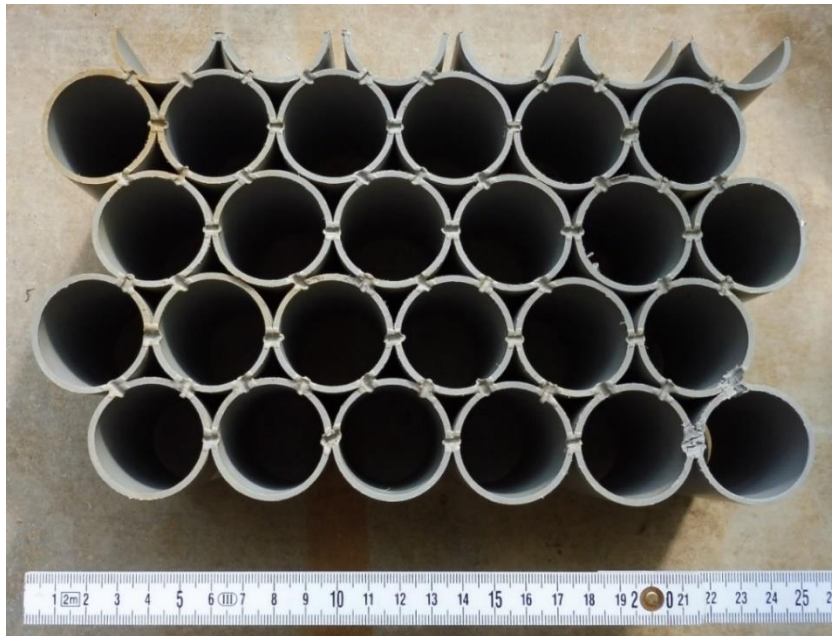
Abbildung 2: Röhrensystem, in dem die Reispflanzen fixiert wurden.
