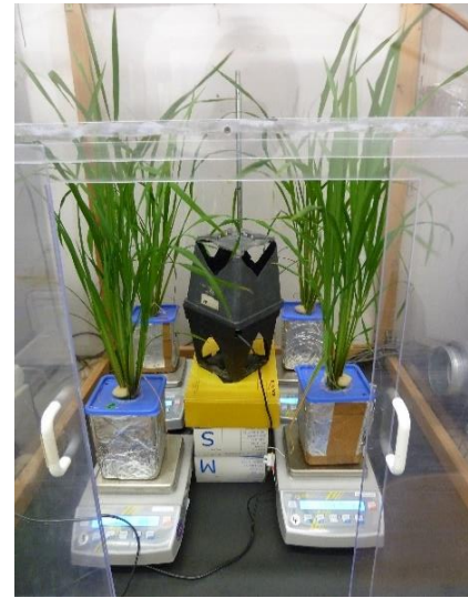
Abb. 4 Anordnung der Pflanzen in der VPD-Kammer
