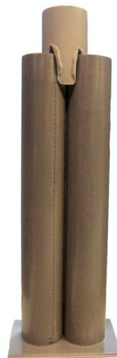
Abbildung 3 Aufbau eines „split-root“-Systems
